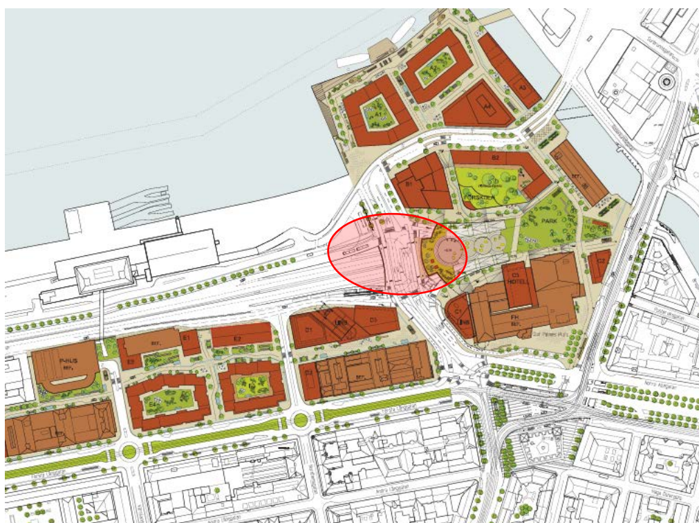
Figur 3. Rödmarkerat område är ett förslag till förbjudet område för stadigvarande verksamhet med avseende på störande underhållsarbete runt tunnelmynningarna
