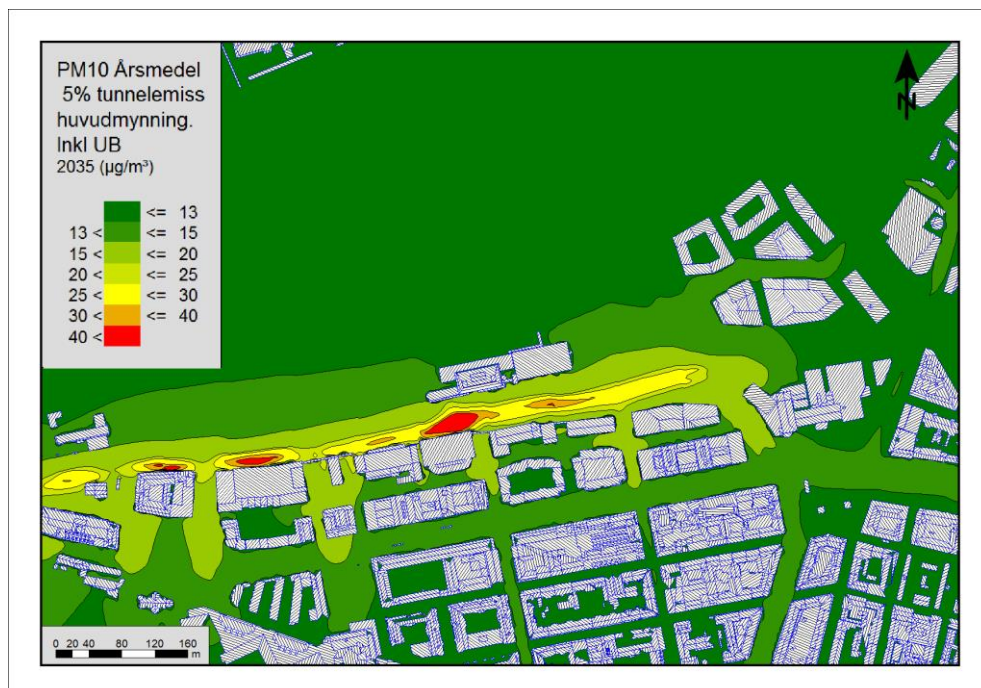
Figur 5 Beräknad total \text{PM}_{10} -halt ( \mu\text{g}/\text{m}^3 ) år 2035 för årsmedelvärdet. Röd haltgräns anger överskridanden av MKN ( 40 \mu\text{g}/\text{m}^3 ).
