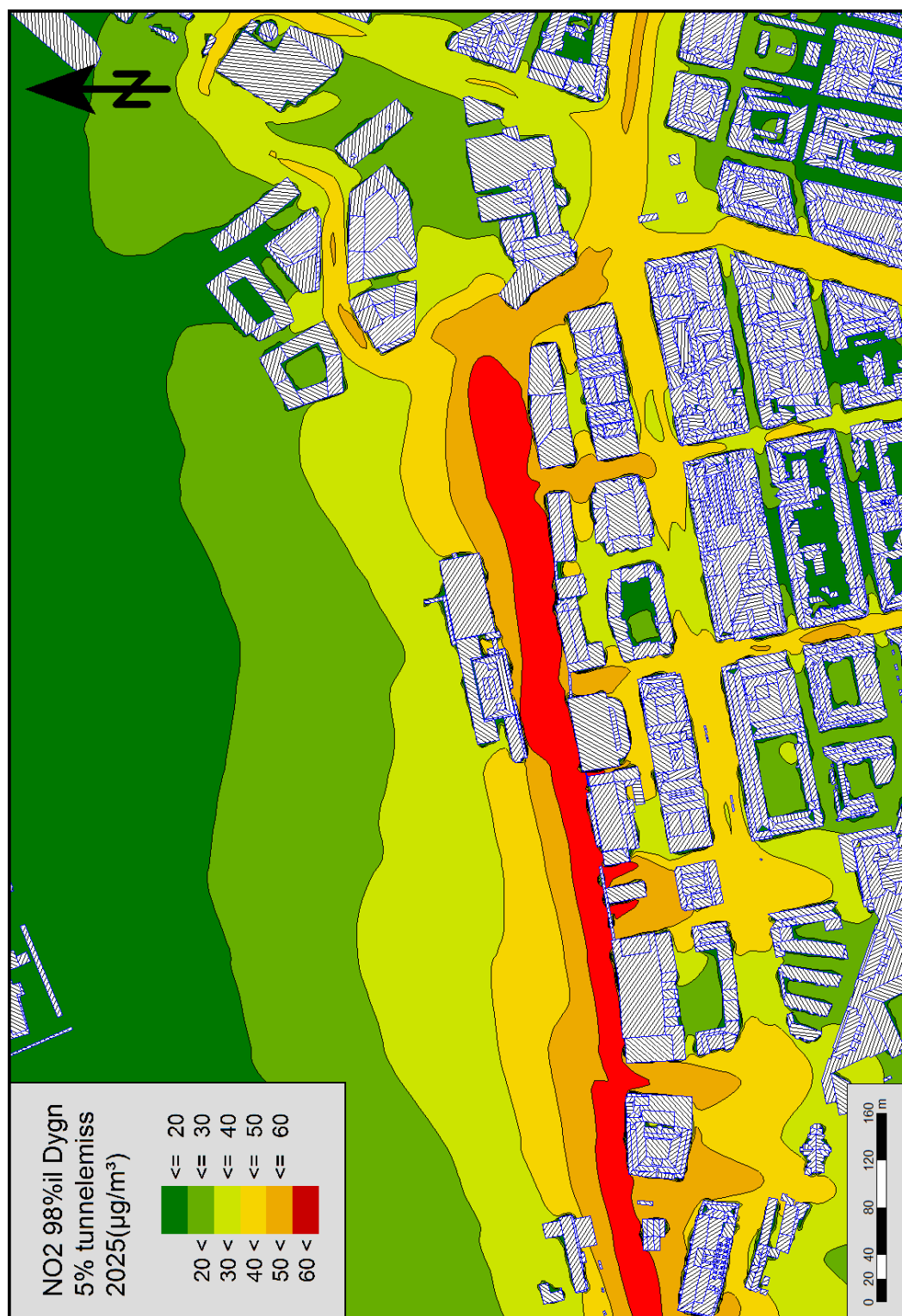
Figur E-2. Beräknade NO 2 -halter (µg/m 3 ) i markplan år 2025 för 98-percentilen av dygnsmedelvärdet. Röd haltgräns anger överskridanden av MKN (60 µg/m 3 ).
